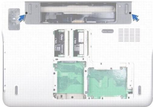
7. Entfernen Sie das optische Laufwerk (siehe [Entfernen des optischen Laufwerks](#)).
